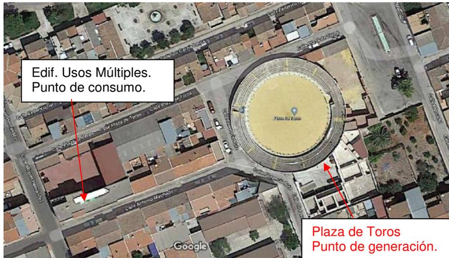
El suministro de energía eléctrica se realiza desde el contador de la compañía, ubicado en el interior del edificio, con el C.U.P.S. ES0031104263449001MP0F, que deriva desde el centro de transformación propiedad de Sevillana Endesa, que se encuentra en el interior del edificio objeto de esta actuación, con acceso desde la calle Miguel Hernández.
