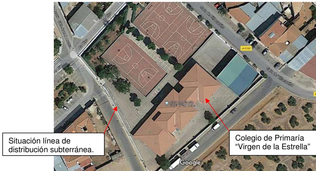
El suministro de energía eléctrica se realiza desde el contador de la compañía, ubicado en el interior del Colegio, con el C.U.P.S. ES0031101756171001YD0F, que deriva desde la línea subterránea de distribución de la compañía que existe en el perímetro del colegio.
